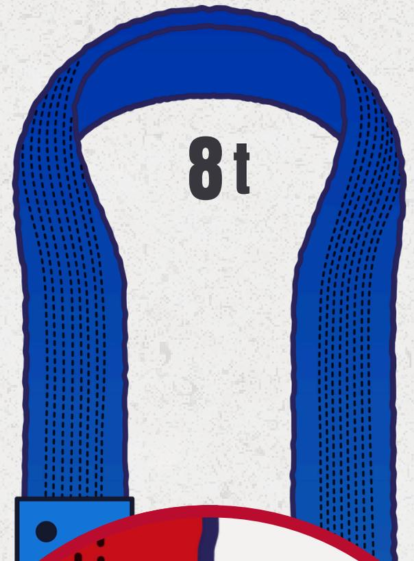
Con frecuencia, las eslingas tienen rayas negras en la cubierta para indicar la capacidad de carga (WLL), y cada raya representa una tonelada de capacidad.
